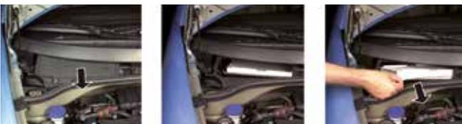
Foto 2 - Innenraumfilter befindet sich hinter dem Motorraum, unter der Windschutzscheibe
