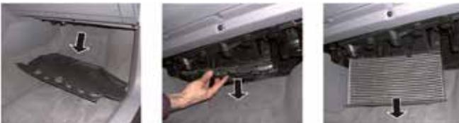
Foto 1 - Innenraumfilter befindet sich hinter dem Handschuhfach
