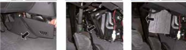
Foto 3 - Innenraumfilter befindet sich in der Nähe der Pedale
